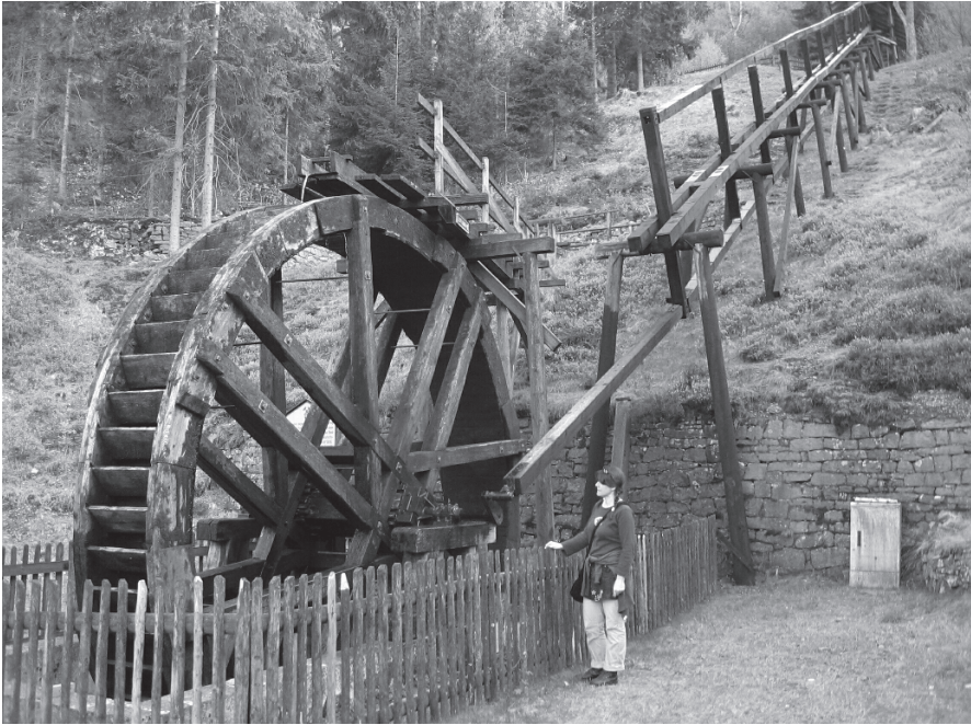
Abb. 12.5. Nachbau eines 6 m hohen Kunstrades, Bergbaulehrpfad am Kranichsberg (Bergwerks- und Geschichtsverein Lautenthal 2002)
