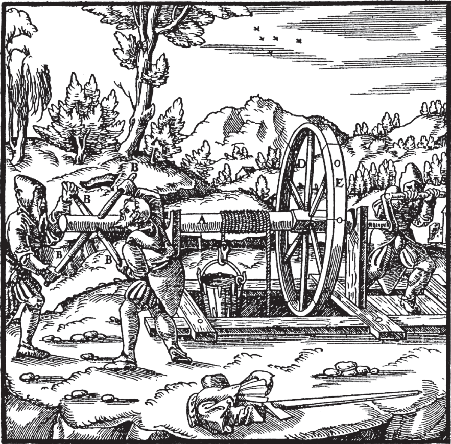
Der Rundbaum A. Die geraden Stäbe, auch Hafselwinden genannt B. Das Hafselhorn C. Die Speichen des Rades D. Die Felgen E.
