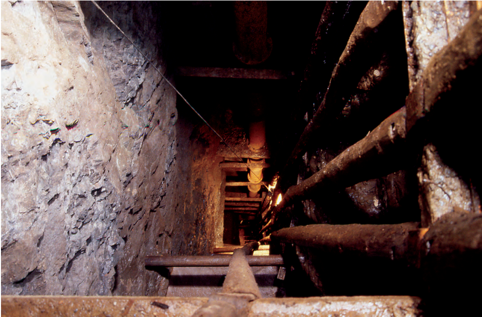
Fig. 30. Blick in den Samsoner Treibschacht von der Grünhirscher Stollensohle nach unten; die Rundhölzer (rechts im Bild) dienen zur Führung der Fördertonne
