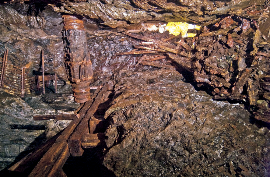
▼ Fig. 35. Kunstradtube der Grube Gnade Gottes auf der Grünhirscher Stollensohle (St. Andre- asberg). Vom Rad ist nur die eichene Welle erhalten geblieben (Foto: K. Stedingk 2008)
