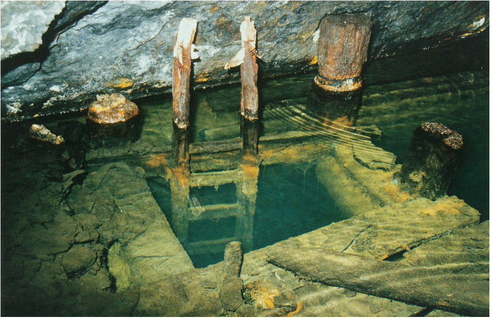
Fig. 41. Wassergefülltes Gesenk mit hölzernen Einbauten aus der Zeit um 1740, Grube Charlotte Magdalena im Schadenbeek, Lauterberger Revier (Foto: 1984)
