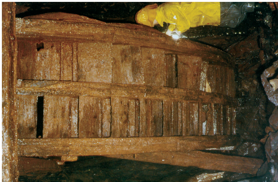
◀ Fig. 26 und 27. ▶ Kombiniertes Kunst- und Kehrroad am Blindschacht der Grube Königin Char- lotte (Burgstättler Gangzug) auf dem Sohle des Tiefen Georg-Stollens. Die Aufnahme rechts zeigt die beiden ent- gegengesetzt ange- ordneten Schaufel- kränze zur Bestim- mung der Drehrich- tung: auf dem Foto links sind die Welle mit einem Seilkorb und der „krumme Zapfen“ zum Anhän- gen des Pumpen- gestänges zu erken- nen (Fotos: 1983)
