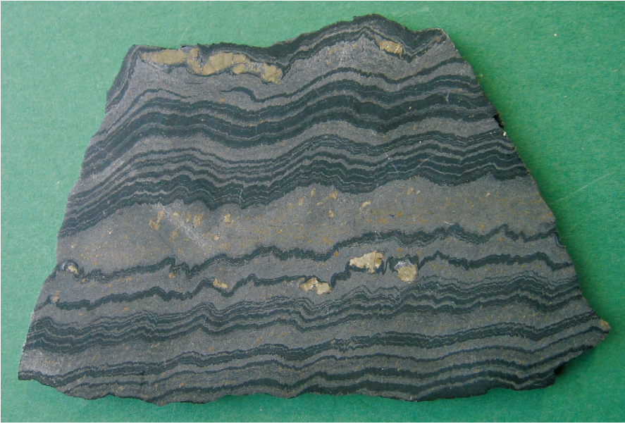
Fig. 11. Banderz – feine Wechsellagerung von karbonatreichen Erz- (hell) und Tonschieferschichten (dunkel), Erzbergwerk Rammelsberg
