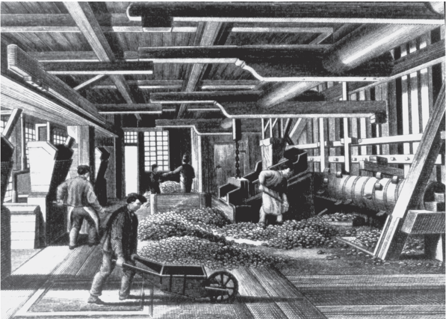
Abb. 6.4. Das Innere des zweiten Clausthaler-Tals-Pochwerks. Rechts im Bild die Pochsätze, in der Bildmitte ein Schüttelsieb (Rätter genannt), links an der Wand stehen Setzmaschinen (Stahlstich nach einer Zeichnung von W. Ripe um 1850)
