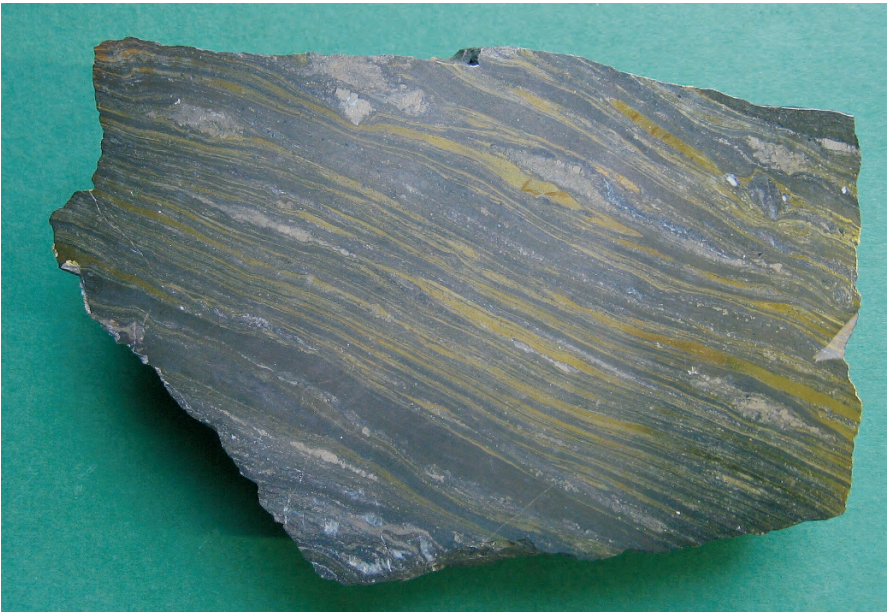
Fig. 12. Melierterz – Reicherz vom Neuen Lager des Rammelsbergs. Parallel ausgerichtete Kupferkiesstreifen liegen in einer dichten Grundmasse aus Bleiglanz und Zinkblende
