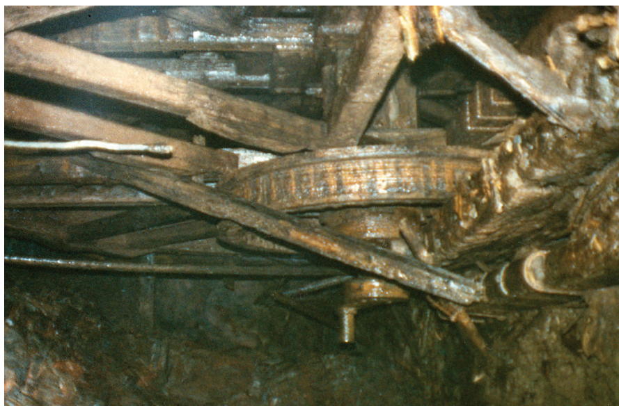
◀ Fig. 26 und 27. ▶ Kombiniertes Kunst- und Kehrroad am Blindschacht der Grube Königin Char- lotte (Burgstättler Gangzug) auf dem Sohle des Tiefen Georg-Stollens. Die Aufnahme rechts zeigt die beiden ent- gegengesetzt ange- ordneten Schaufel- kränze zur Bestim- mung der Drehrich- tung: auf dem Foto links sind die Welle mit einem Seilkorb und der „krumme Zapfen“ zum Anhän- gen des Pumpen- gestänges zu erken- nen (Fotos: 1983)
