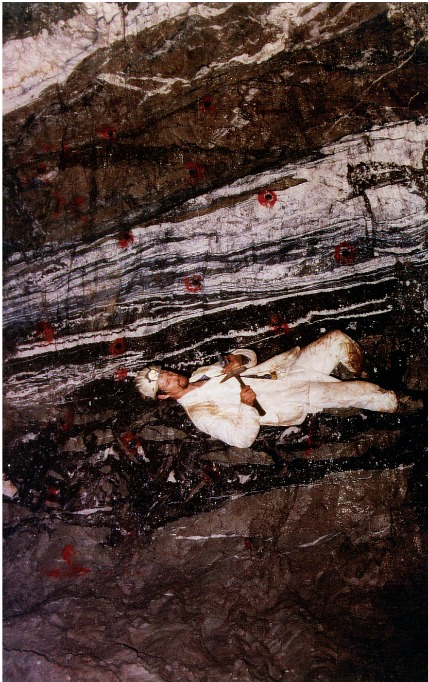
Fig. 3. Abbaustoß mit Zinkblende-Bleiglanz-Kalkspat-Erzen, teils Bändererz, teils mit Zinkblende verkittete Grauwackebruchstücke (Gangbrekzie). Erzbergwerk Grund, Westfelderzmittel II, Silbernaaler Hauptgang, M2-Trum, 18. Firste, Baufeld 1818 W, 25. Stoß (Foto: Mai 1987)
