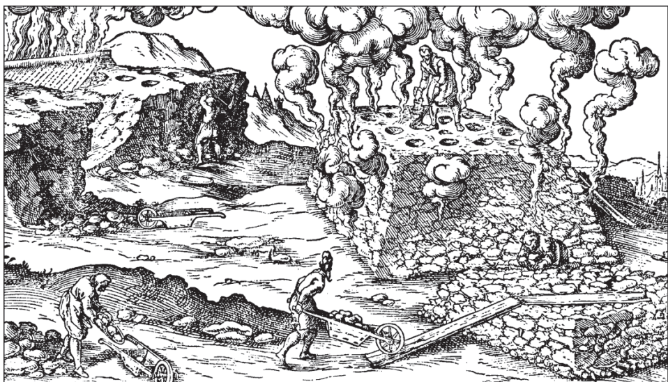
Abb. 6.8. Haufenröstung von Rammelsberger Erzen nach Löhneyss (1617). Der große Haufen rechts ist in vollem Brand. Ein Mann schöpft Schwefel aus den napfförmigen Mulden. Vorn rechts wird das bereits einmal geröstete Erz zu einer zweiten Röste aufgebaut (aus Rosenhainer 1968)
